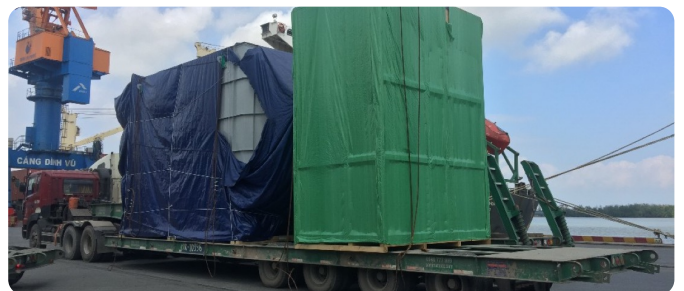
Máy biến áp trên rơ-moóc lùn tại cảng
